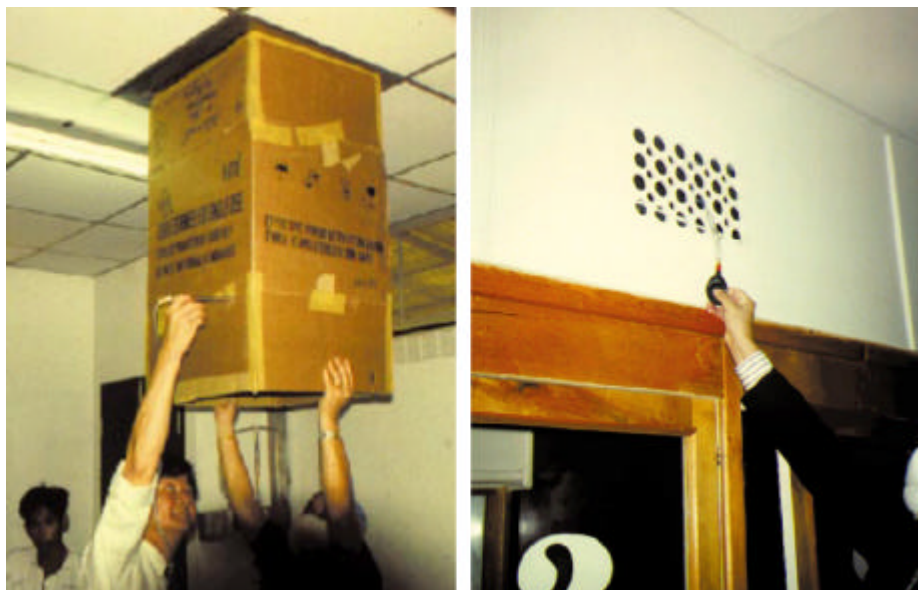
Использование картонной коробки и ротаметра для контроля воздушного потока в боксе для больных ТБ, оборудованном механической вентиляционной системой, больница в г. Чианграй (Таиланд)
